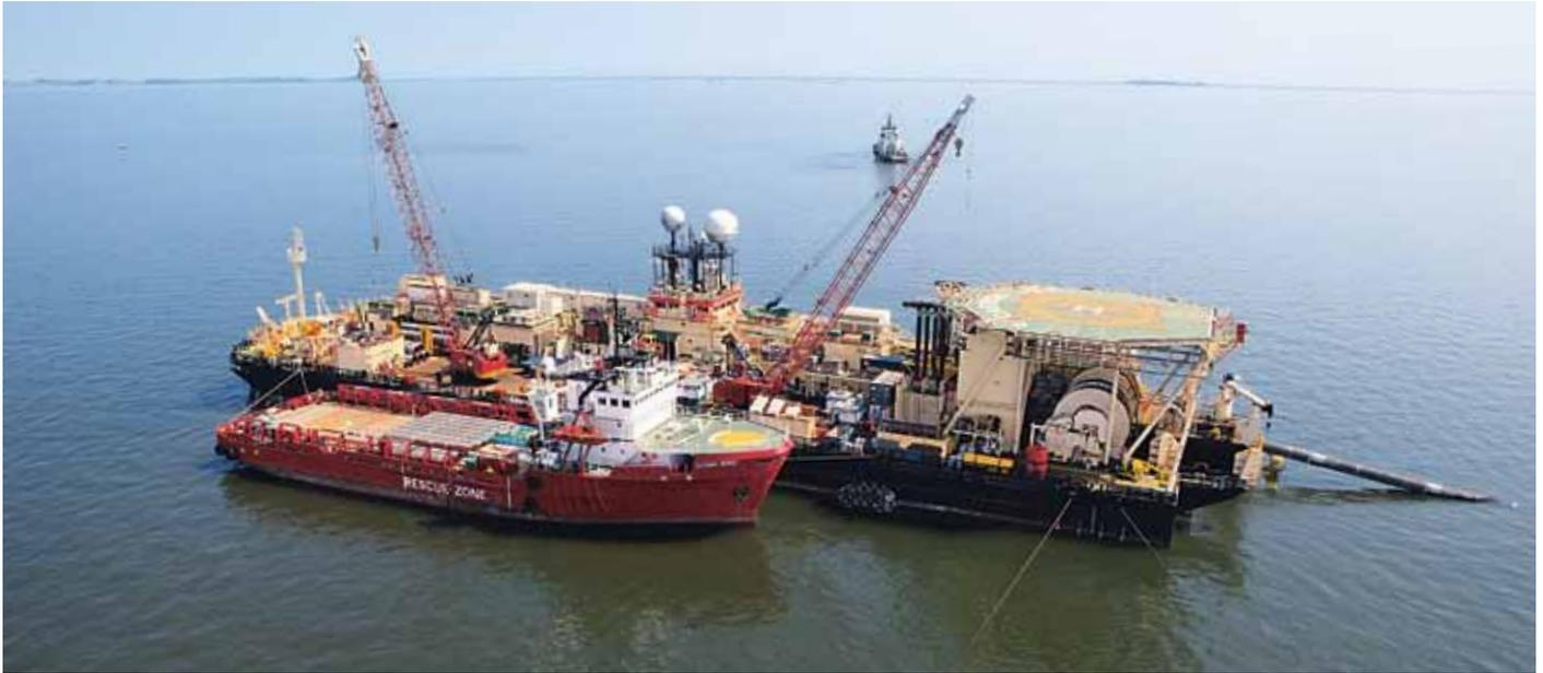
Die Castoro Dieci, ein Verlegeship mit speziell flachem Rumpf, begann im Juni mit den Verlegearbeiten in den seichten Gewässern des Greifswalder Boddens. Sie verlegt das kürzeste Teilstück (28 Kilometer) der Pipeline.
